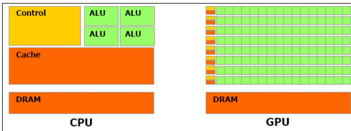
Figura 1: Comparación del uso de transistores entre CPU y GPU (NVIDIA 2007)
