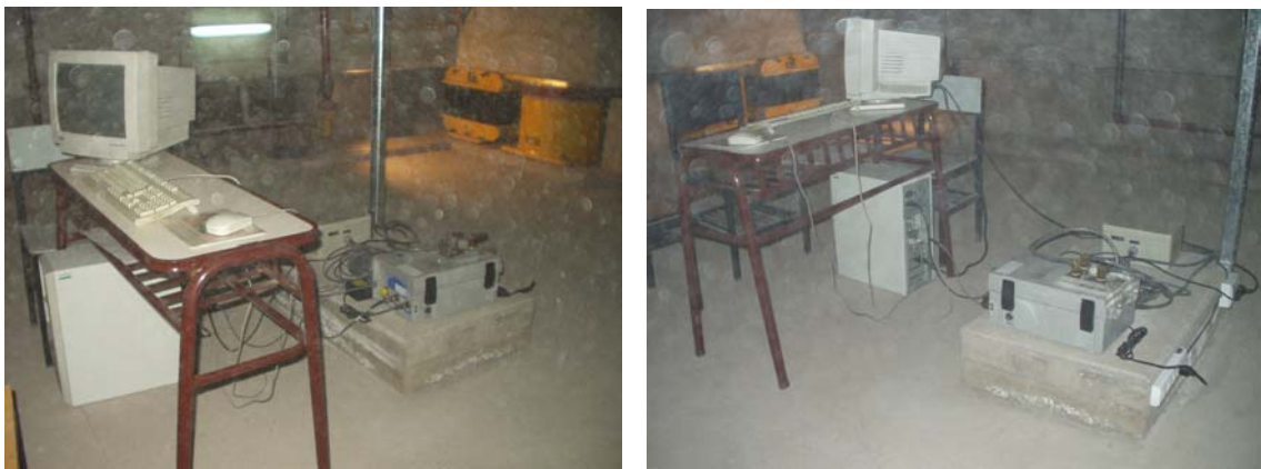
Fig. 9.34: Central de adquisición de datos (Altus K2 de Kinemetrics – PC para comunicación y procesamiento de los registros sísmicos).
