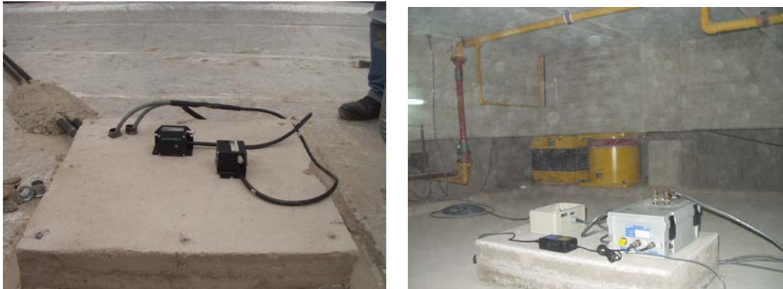
Fig. 9.30: Base de hormigón simple para fijar los sensores externos y el Altus K2.
